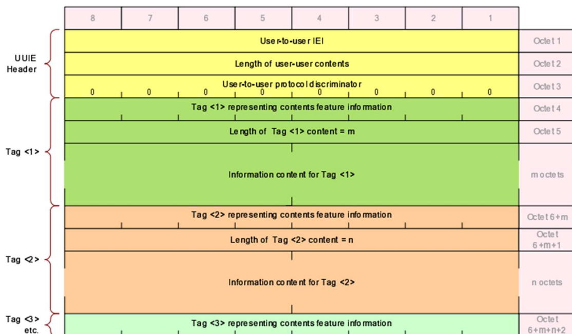
Figura 10 - Formato de codificação genérico para elementos de informação “User-to-User” (UUIE) usando protocolo específico do utilizador no contexto GSM-R (de ETSI TS 102 610)
